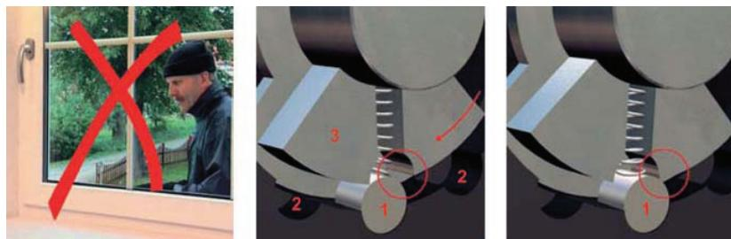
Při pokusu o vlopání jsou zajišťovací kolíky 1. spojovacím prvkem 3. zatlačeny dodržekem v pouzdře 2.
