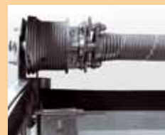
Komfort ovládání torzní pružina vyvažuje hmotnost vrat
